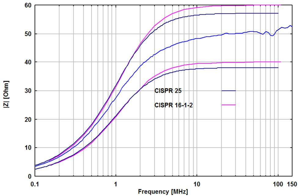
Abb. 2: Betrag der Impedanz an den Prüflingsklemmen, BNC mit 50 Ω abgeschlossen
