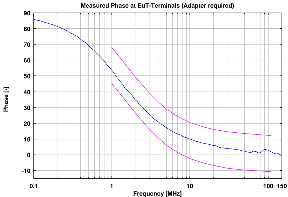
Abb. 3: Phase der Impedanz gemessen an den Prüflingsklemmen, BNC mit 50 Ω abgeschlossen
