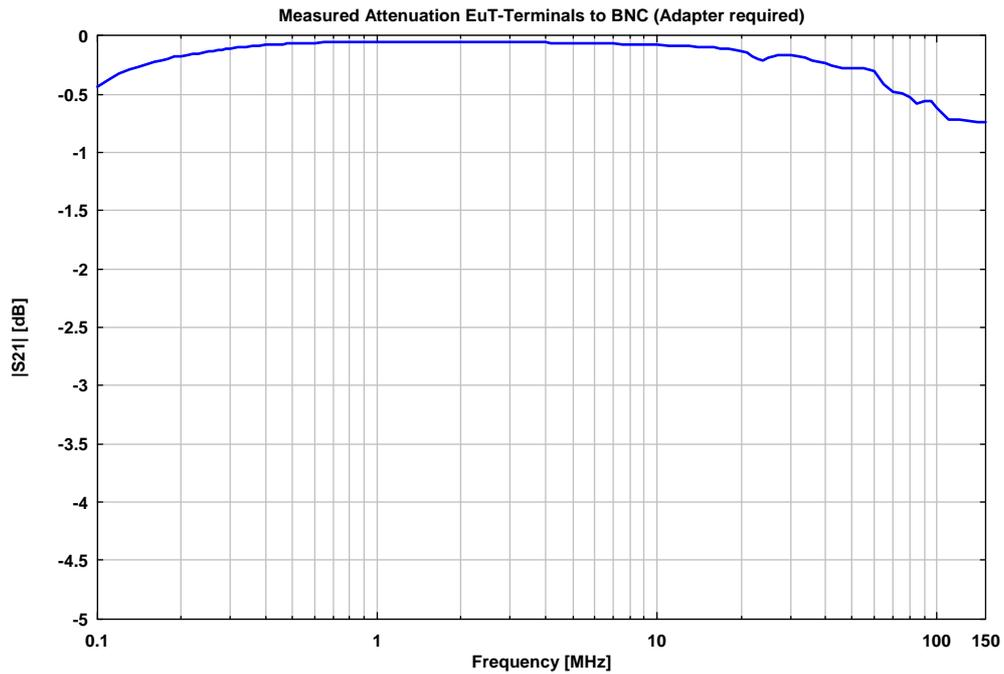
Abb. 4: Transmission EuT nach BNC
