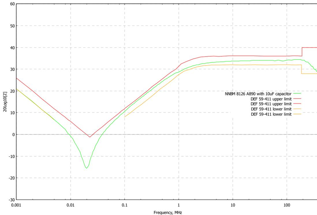
Abb. 6: Betrag der Impedanz an den Prüflingsklemmen nach DEF STAN 59-411, BNC mit 50  $\Omega$  Abschluss, 10  $\mu$ F Kondensator an den Speiseklemmen.
