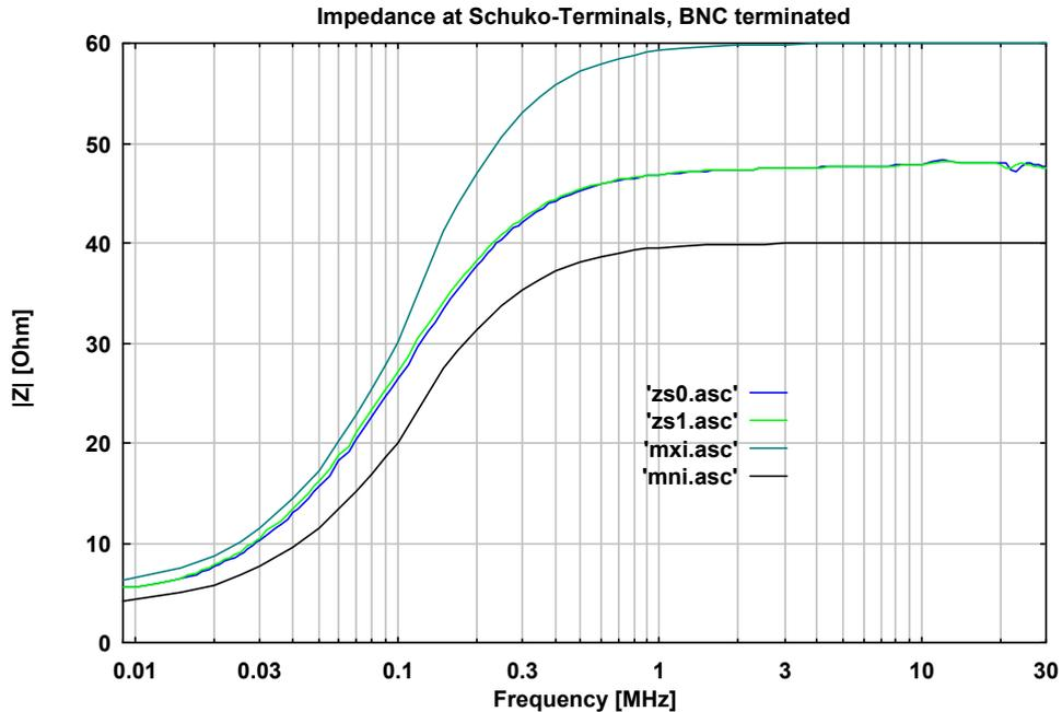
**Abb. 4 Betrag der Impedanz an den Prüflingsklemmen, BNC mit 50 Ω Abschluss**
