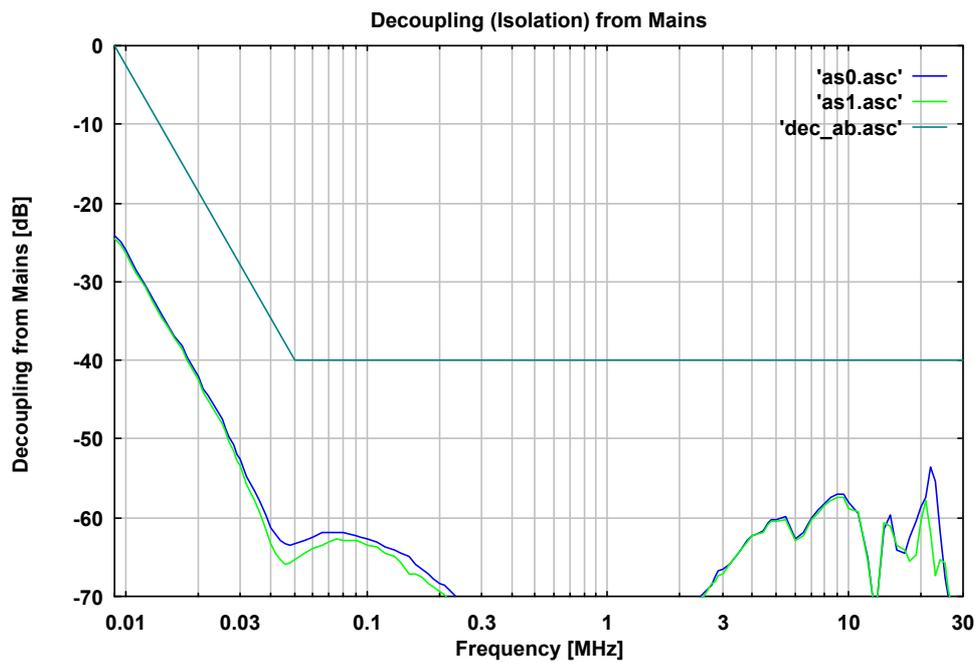
**Abb. 6 Entkopplung vom Speisetz (Prüflingsklemmen)**
