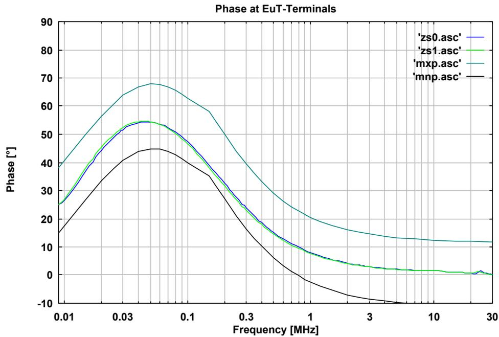
**Abb. 5 Phase an den Prüflingsklemmen, BNC mit 50 Ω Abschluss**
